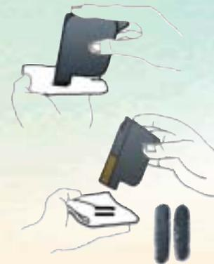
**3** Préparer une des bille et poser la sur l'orifice de remplissage. Presser sur les flancs pour que l'encre apparaisse.
