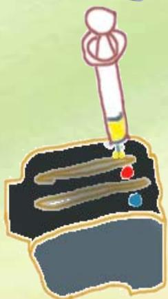
**2** Préparer la pompe de remplissage avec la couleur souhaitée. Purgez l'air à l'intérieur de la pompe. **Enfoncer l'aiguille en totalité dans la mousse et injecter lentement.** La recharge maximum est de 10/12 ml par couleur. Dès que l'encre apparaît, arrêter. Répéter l'opération pour chaque couleur. Nota : Le volume d'encre injecté durant une recharge peut être supérieur à la contenance initiale de la cartouche.
